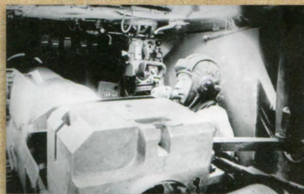
★ Интерьер самоходной установки СУ-152. На переднем плане — массивная казенная часть 152-мм пушки-гаубицы МЛ-20 с открытым поршневым затвором. За ней, на своем рабочем месте, — командир машины, перед открытым посадочным люком которого установлена панорама ПТК-4. Курская дуга. 6 июля 1943 года.
